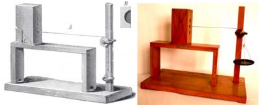
Weinhold-féle készülék az állásszilárdság bemutatására
