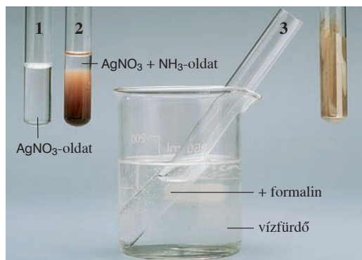
149.2. Ezüsttükörpróba. Miért nem nyílt lángon melegítjük a kémcsövet?
