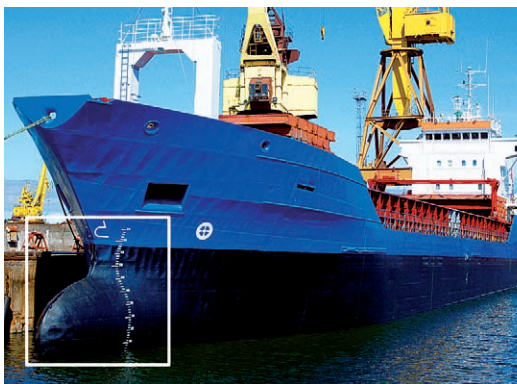
144.2. A hajók átlagsűrűsége kisebb a víz sűrűségénél. A merülési mélységet a vízvonallal jelzi a hajó oldalán
