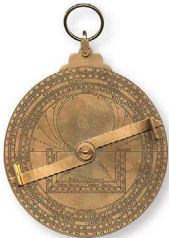
40.1. Korabeli műszer. A hajó helyzetének meghatározására szolgált
