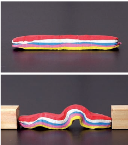
60.2. Az oldalirányú erők hatására a rétegek redőkbe rendeződnek
