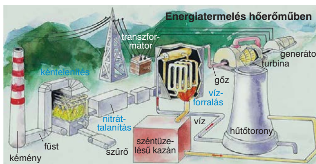
245. ábra. A hőerőművekben előállított gőzzel turbinákat hajtanak meg, amelyek mozgási energiáját a generátor villamos energiává alakítja át. A szén elégetésekor azonban kén- és nitrogéntartalma a levegőbe jutna, ha a kiáramló füstöt nem szűrnék át filtereken.
