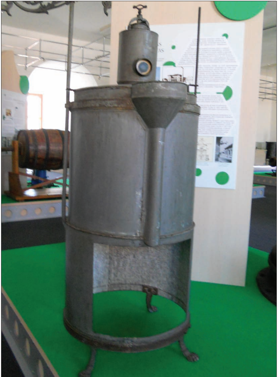
2. kép Az acetilén lakásvilágításhoz használt gázfejlesztő tartály
